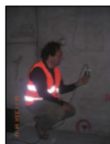
Εικόμα Α2-13. Στάθμη ταχύτητας δόνησης στον τοίχο της σήραγγας ΤΒΜ στο C/O 27 στη Χ.Θ 14.583 στο Νομισματοκοπείο στην επέκταση Σταυρού. Κατηγορία Εδάφους 2Α+3Β
